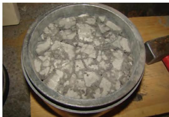
Рис. 2. Экспериментальное определение прочности пеностекляного щебня на сжатие при различных степенях уплотнения (слева – пресс для определения прочности материала, справа – образец после испытания)
