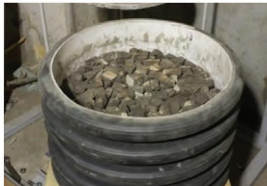
Рис. 1. Проведение экспериментальных определений максимальной степени уплотнения щебня из пеностекла (слева – оборудование для уплотнения щебня, справа – уплотненный образец материала)
