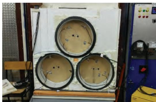
Рис. 3. Экспериментальные определения теплопроводности пеностекляного щебня в сухом состоянии при различных степенях уплотнения (слева – образец с закрепленными датчиками температур и тепловых потоков, справа – климатическая камера для определения теплопроводности)
