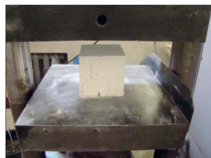
Рис. 7. Испытание на прочность при сжатии образцов пеногипса по ГОСТ 10180
