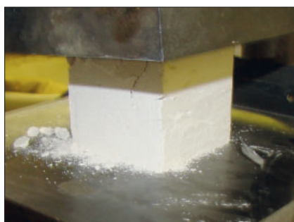
Рис. 7. Испытание на прочность при сжатии образцов пеногипса по ГОСТ 10180
