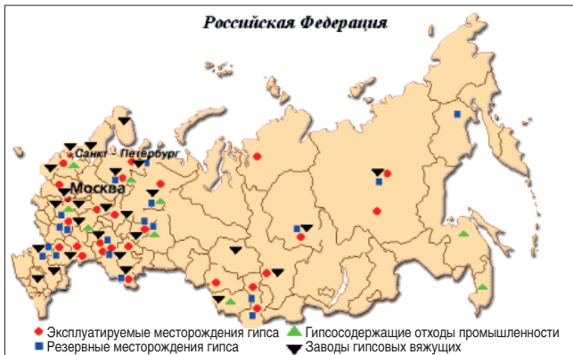
Рис. 1. Схема расположения источников сырья относительно центров потребления строительного гипса
